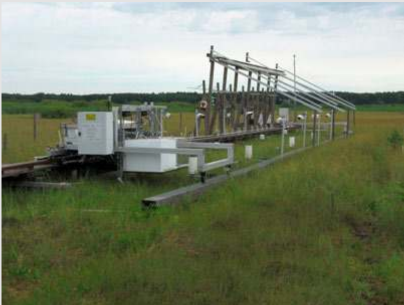
Fot. 5. Zaawansowana technicznie automatyczna stacja do pomiaru bilansu gazów cieplarnianych i do eksperymentów manipulacyjnych ze zmianą opadu i temperatury, na Torfowisku Rzezińskim w Puszczy Noteckiej w Wielkopolsce. Fot. J. i P. Pawlaczykowie.
